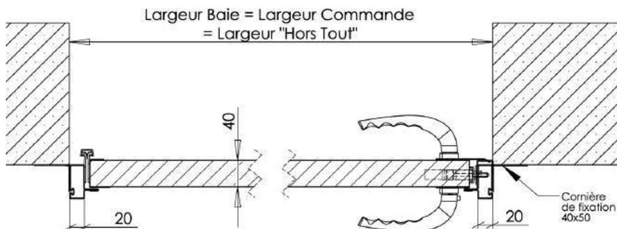
Côté technique, les huisseries sont des tubes **acier thermolaqués de 50x20** couplés à des **cornières de 40x50** pour permettant une **pose en applique ou en tunnel**.
